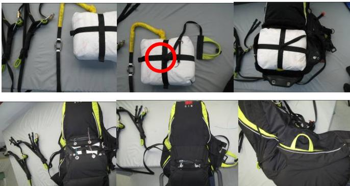
Der Rettungsschirmauslösegriff muss in der korrekten Position am Innenkontainer befestigt werden und der Innenkontainer muss in der richtigen Weise in das Gurtzeug eingebaut werden.
