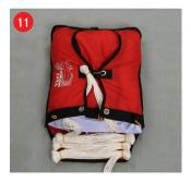
Utilisez des élastiques pour tenir les boucles. Placez l'ensemble des boucles à l'arrière du container.
