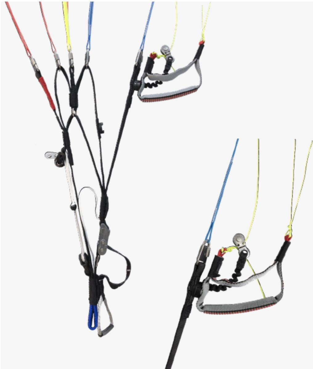
Figure : élévateurs Falcon 2
