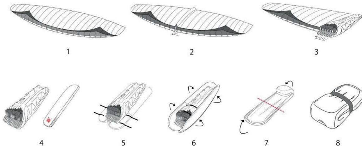
**Abbildung:** Richtiges Packen des Yeti Tandem 3
