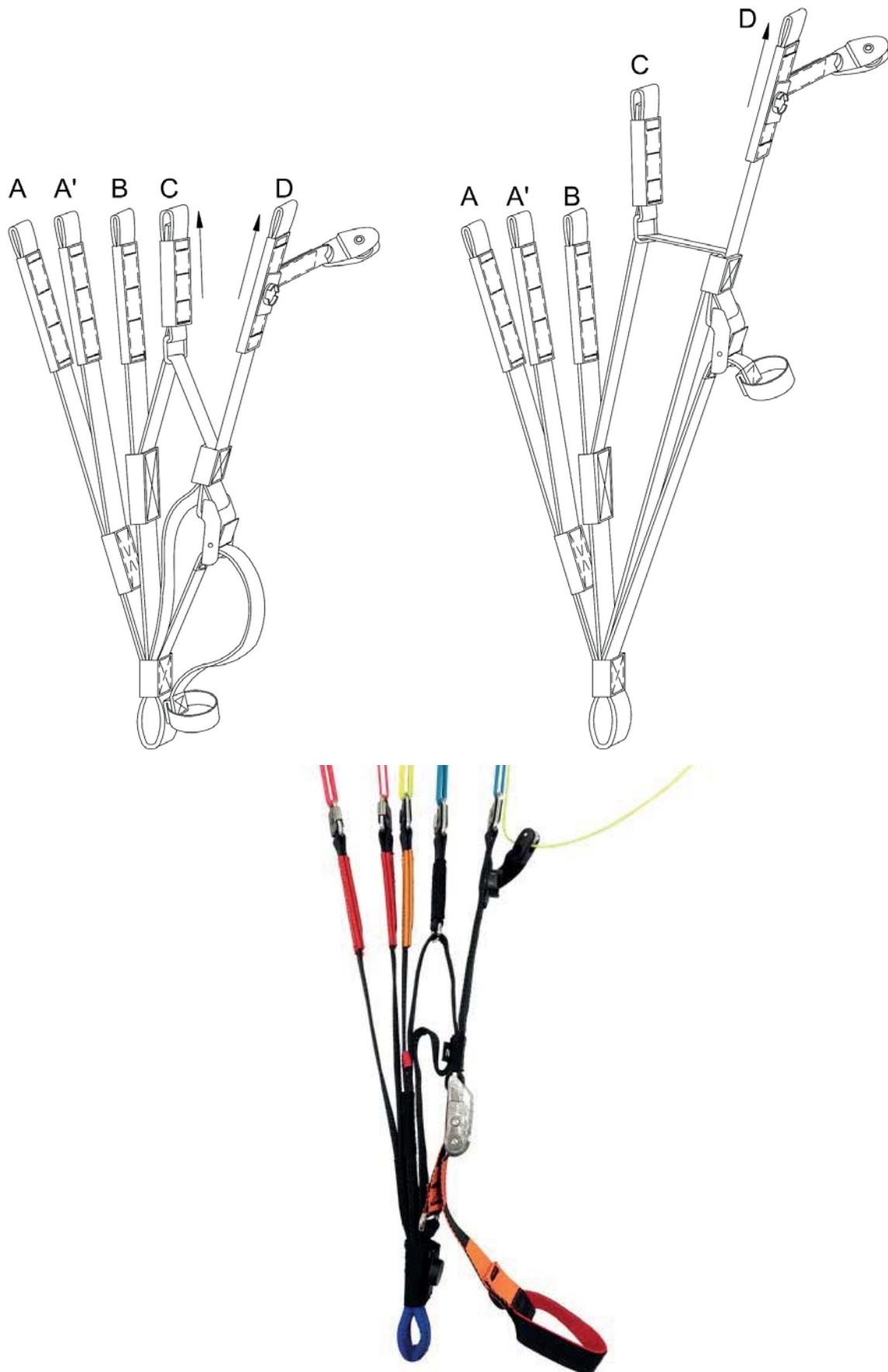
Abbildung: Optionaler Yeti Tandem 3 Tragegurt (12 mm Kevlar oder 20 mm Gurtband Version)
