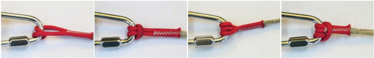
Abbildung: Erlaubte Schlaufen auf den Schraubschäkeln
