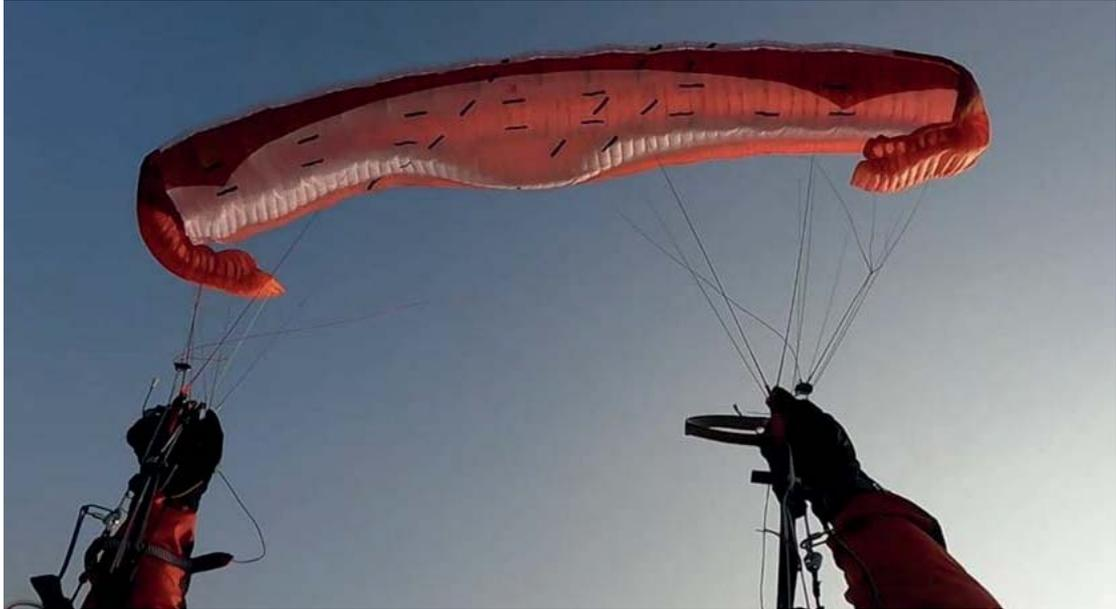
**Abbildung:** Boomerang 12 in einem stabilen Sackflug nach einem frontalen Einklapper. Die Hinterkante des Gleitschirms geht nach oben, was verhindert, dass der Schirm in den normalen Flug zurückkehrt.
